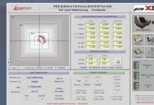
PCB-STAT-2000 Statistische Auswertsoftware für Bohren und Konturberechnungen. Prozeffähigkeits Analysen integriert.
